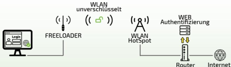
Verbindung zum WLAN-HotSpot erfolgt ohne WLAN-Key Eingabe. Der Freeloader ist mit dem HotSpot verbunden, jedoch nicht mit dem Internet. Klicken Sie den Button „WEB-Registration Login“ im Freeloader-Menü, um auf die Anmeldeseite des HotSpot-Betreibers zu gelangen. Geben Sie dort die Zugangsdaten ein, oder folgen Sie den Anweisungen auf der Seite.
