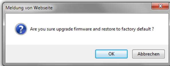
6. Firmware wird aktualisiert, dieser Vorgang kann bis zu 2 Minuten dauern. Schalten Sie das Gerät in dieser Zeit nicht aus.
