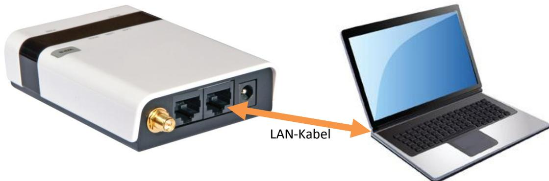
2. Am Router mit der IP 192.168.8.8 (nach einem Reset ist die IP 192.168.2.1) anmelden und auf "Advanced / Management" klicken.
