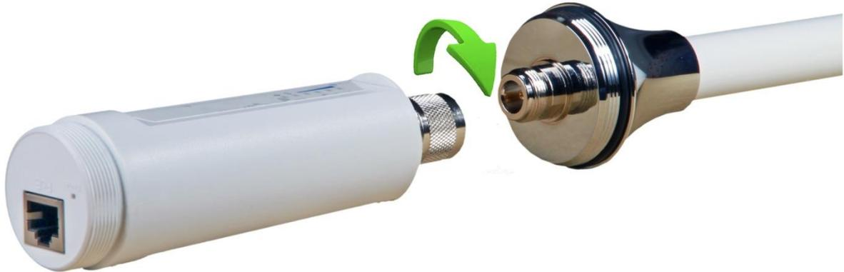
Verbinden Sie das Antennenelement mit der Antennenelektronik. Für optimale Verbindung ziehen Sie die Verschraubung mit einer Zange leicht an.
