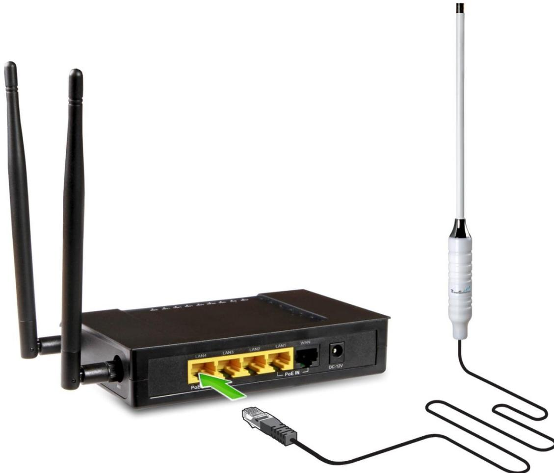
Verbinden Sie das Anschlusskabel der Antenne mit dem Port **LAN4** an dem WLAN-Router.
