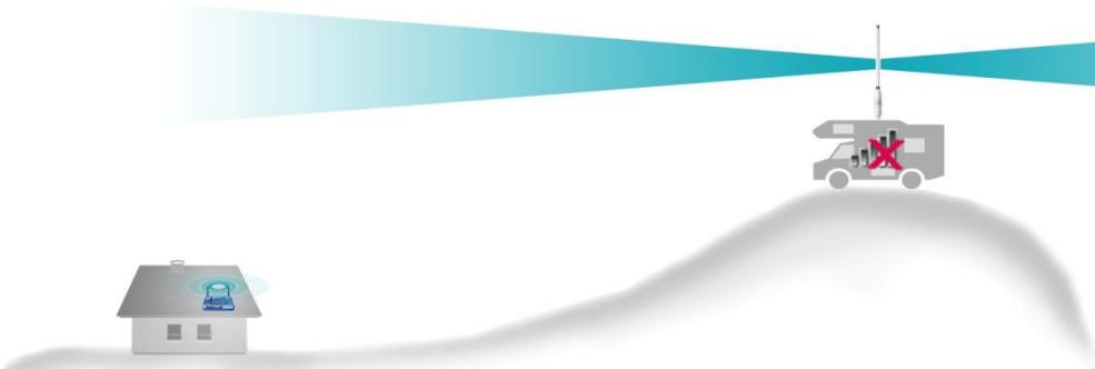
Jedes Hindernis zwischen Antenne und Gegenstation schwächt die WLAN-Funkwellen durch Reflexion (Zurückwerfen) oder Ablenkung ab. Daher ist ein optimaler Standort der Antenne ausschlaggebend für eine optimale WLAN-Verbindung.
